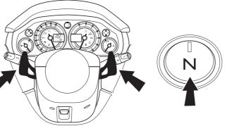
ASM. EITHER: PULL BOTH PADDLES WITH THE IGNITION ON.
