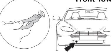
REMOVE PLUG FROM LOWER FRONT GRILL TO LOCATE TOWING EYE APERTURE
