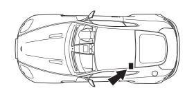
THE TOWING EYE IS LOCATED IN THE TOOLKIT UNDER THE REAR STOWAGE FLOOR PANEL BEHIND THE LH SEAT.
